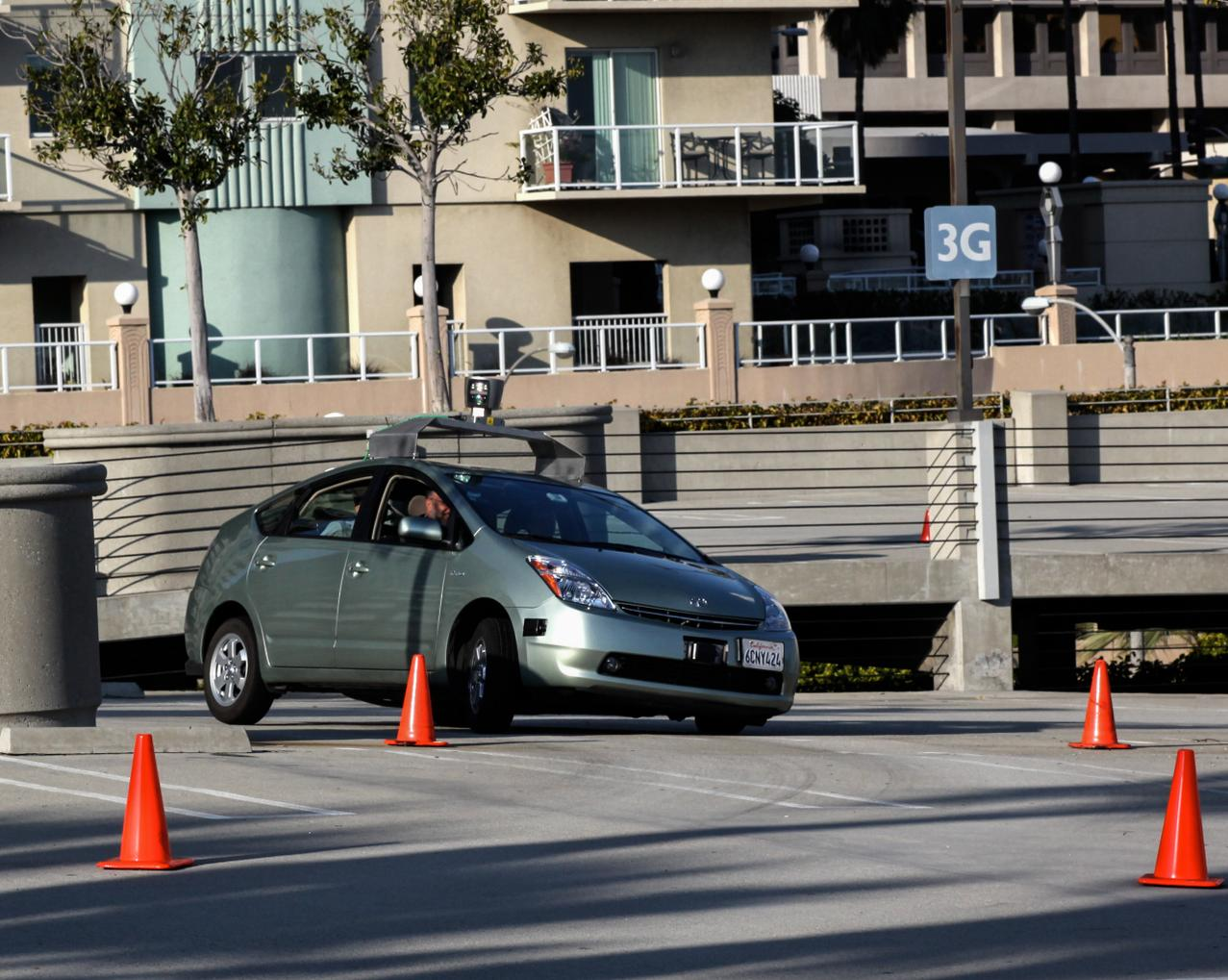
El automóvil sin conductor de Google (*Google driverless car*) es un proyecto de la multinacional de Mountain View. En la foto un Toyota Prius, automóvil híbrido gasolina-eléctrico, circula por una pista de pruebas con un equipo instalado en su techo cuya pieza fundamental es un sistema LIDAR (*Light Detection and Ranging*), que permite determinar —mediante un haz láser— la distancia desde el coche a cualquier objeto o superficie (Steve Jurvetson, cortesía de Wikipedia)
