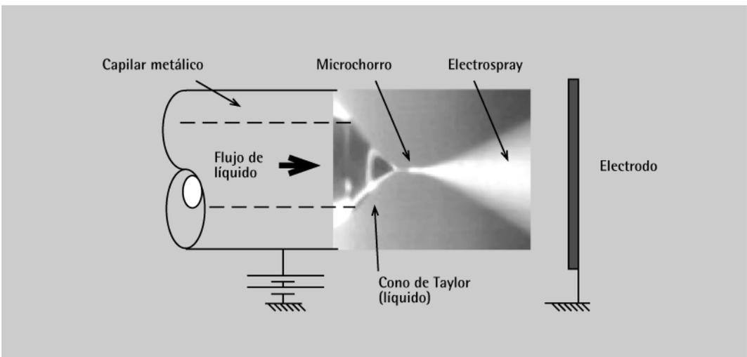
Figura 1. Esquema de una fuente de electrospray.
